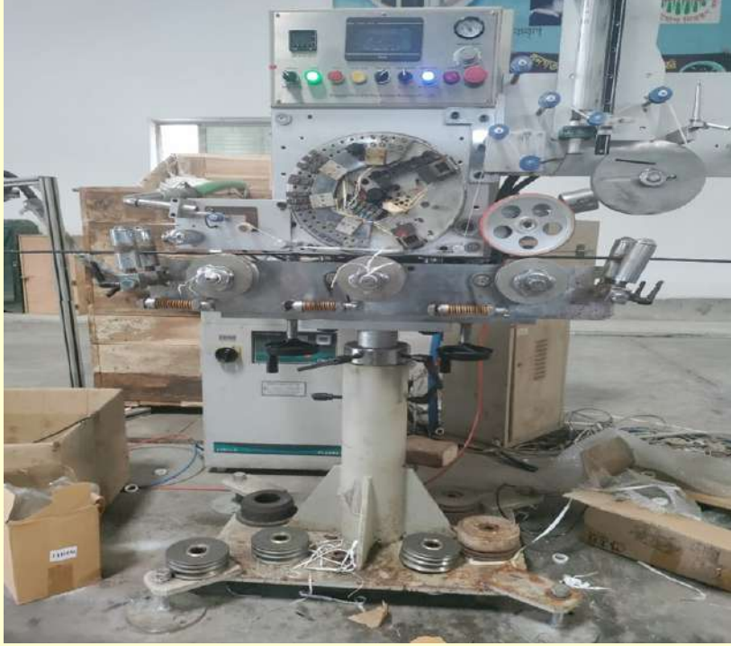
অপটিক্যাল ফাইবার ক্যাবল এর উপর মার্কিং করার জন্য নতুন স্থাপিত High Speed Hot Foil Marking Machine।
